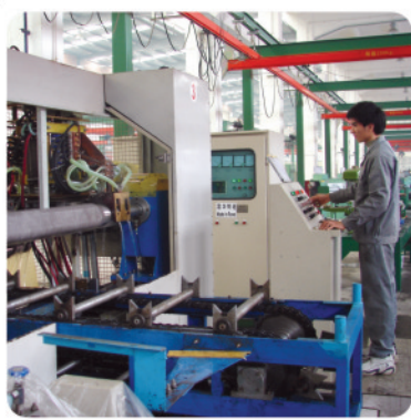
中频淬火 Heat Hardening
